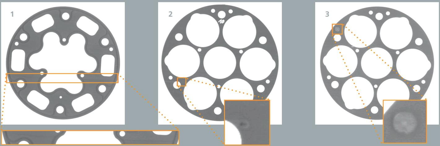
**1-3** Kratzer, Blase und Delle als Defektbeispiele; die Dichtungen sind in etwa im Maßstab 1:2 abgebildet.
