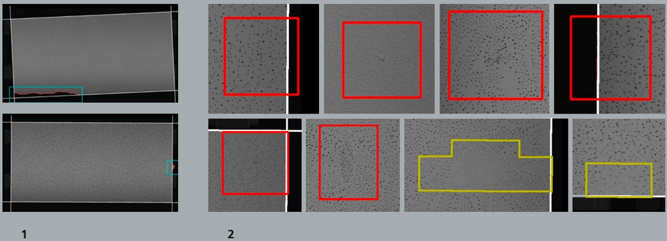
1 Deckenplatten mit detektierten Kanten: Typische Geometriefehler sind Kantenausbruch (oben) und Überstand (unten).
