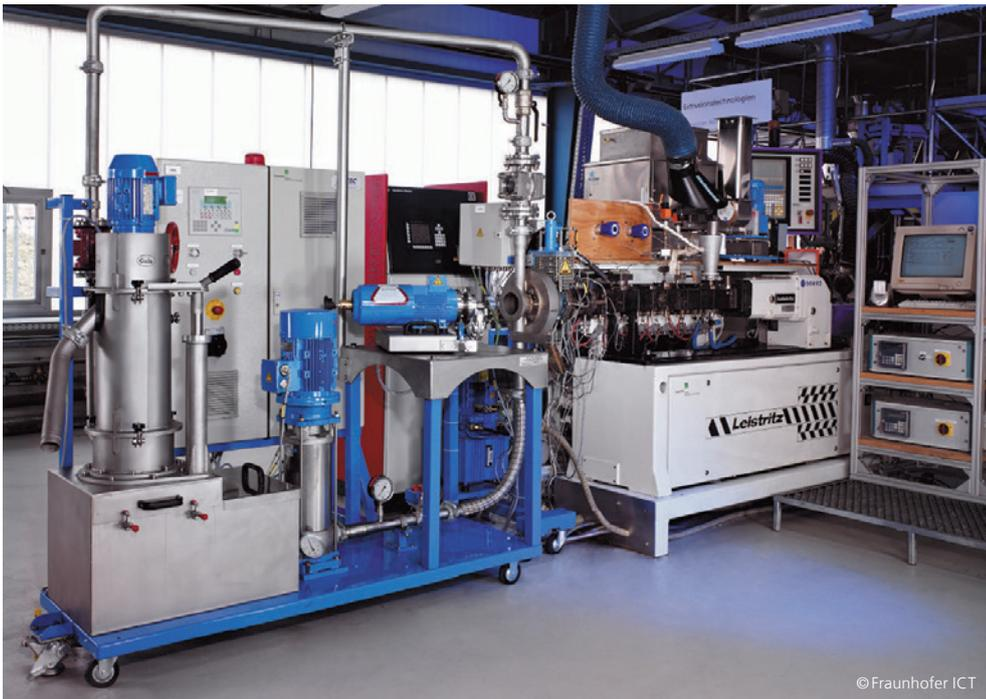
Dem Fraunhofer ICT steht ein modern ausgestattetes Technikum mit Doppelschneckenextrudern von 16–43 mm sowie vielseitigen Dosiermöglichkeiten zur Verfügung.
