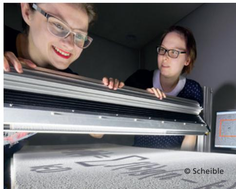
Oberflächen eine Vielfalt an Fehlerarten wie Kratzer und raue Stellen zu erkennen, es misst aber auch den Farbauftrag. Dadurch wird sichergestellt, dass die Farbsprühanlage nicht mehr Farbe verbraucht als benötigt wird für ein gleichmäßiges Erscheinungsbild der Deckenplatten.
