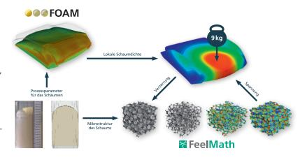
Schaumdichte in einem Bereich zwischen 50 und 100 kg/m³.
