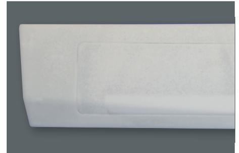
Messung technischer Kunststoffe am Beispiel einer Airbag-Abdeckung: Die Dicken der Sollbruchstelle sind überprüfbar.
