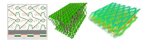
Erzeugung der Struktur vom Abstandsgewirke, Visualisierung mit Markierung einzelner Garne, Simulation vom Zug in der Ebene und weitere Kompression mit Software. TexMath. ©Fraunhofer ITWM
