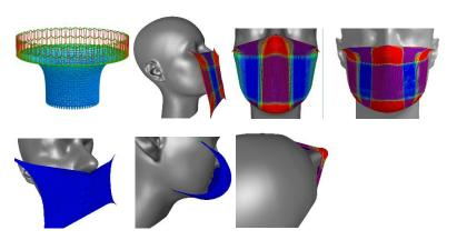
Simulation von Stricken (Abzug aus der Maschine) und des Anziehens einer Maske. Farben geben Aufschluss über Spannung. Einfluss der Gesichtsform und Strickspannung auf das Anliegen wird demonstriert. ©Fraunhofer ITWM
