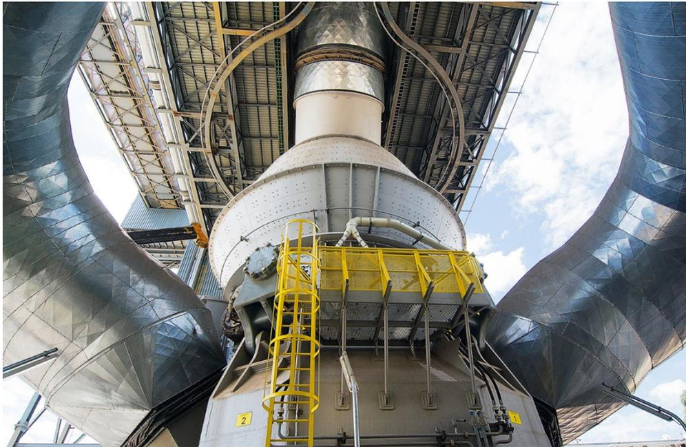
Eine Zementmühle des Materialaufbereiters Gebrüder Pfeiffer SE; wie die im Betrieb entstehenden Schwingungen reduziert werden, untersuchen Forschende im Verbundprojekt EMILIE.
