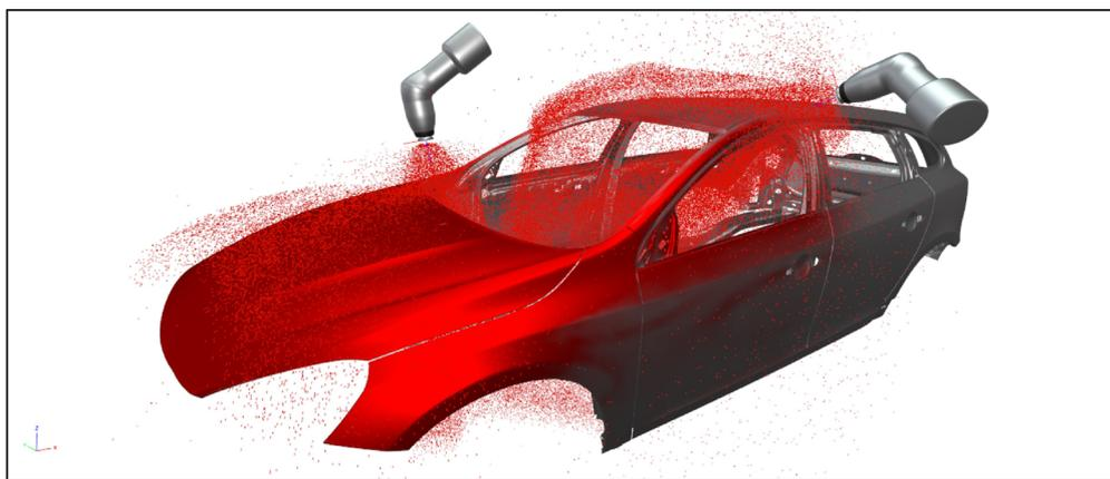
**Multiphysikalische Simulation eines Hochrotationszerstäubers mit Kontaktaufladung zur Berechnung der Tropfenflugbahn am Beispiel einer Volvo V60 Karosserie. © Fraunhofer FCC | Bild in Farbe und Druckqualität: [www.fraunhofer.de/presse](http://www.fraunhofer.de/presse).**
