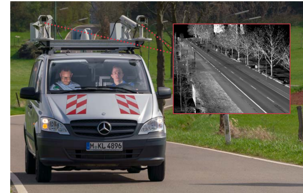
▲ Wissenschaftler auf Achse: Um 3D-Umweltdaten als Basis für realitätsnahe Simulationen zu erfassen, hat das Team ein Fahrzeug mit modernster Lasermesstechnik entwickelt.
