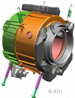
Als Demonstrator für das Projekt dient der Laugenbehälter einer Waschmaschine.
