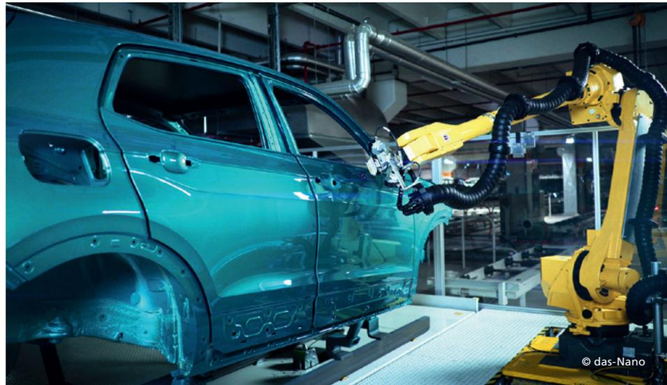
Um fehlerhafte Lackierungen zu erkennen, muss nicht jedes Auto einer eingehenden Prüfung unterzogen werden. Es reicht in etwa jedes zehnte, denn dass von einem Auto zum nächsten Auto etwas schiefeht, ist ausgeschlossen. Man erkennt Tendenzen und entdeckt frühzeitig, welcher Lackierroboter nicht richtig arbeitet, weil beispielsweise die Farbschicht immer dünner wird.
