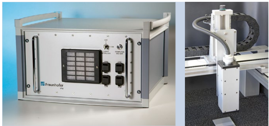
Bild 2: Fasergekoppeltes Terahertz-Messsystem, bestehend aus Basiseinheit und Messmodul. Die Basiseinheit enthält die zum Betrieb notwendige Optik und Elektronik sowie einen Rechner zur Systemsteuerung. Die Messmodule können individuell ausgelegt werden; im Bild rechts ist das Messmodul auf einem XY-Scanner montiert.
