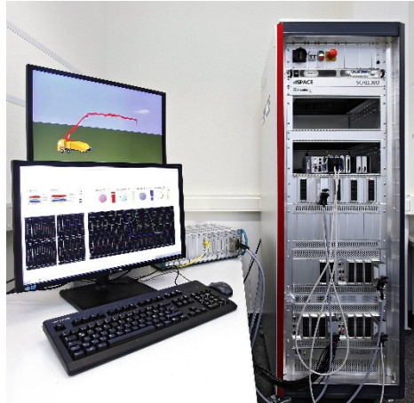
Abb. 2 Die HiL-Plattform des Fraunhofer ITWM ermöglicht Datenerfassung und -generierung vieler Signaltypen sowie komplexe Fehlersimulationen. Die Regelungsalgorithmen können auf den eigenen Steuereinheiten implementiert oder die originalen Kundensysteme eingebunden werden.
