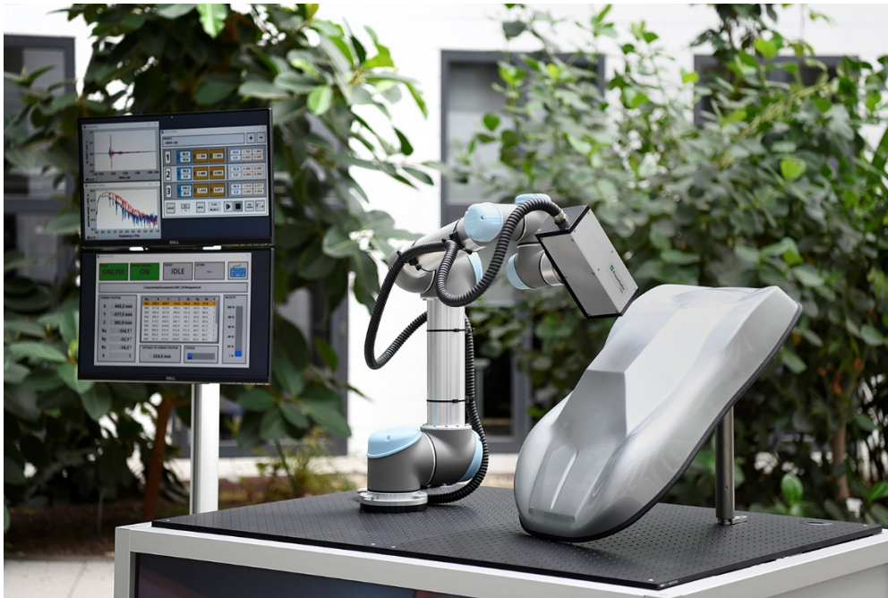
Ein Kurzpuls-Terahertz-Sensor © Fraunhofer ITWM
