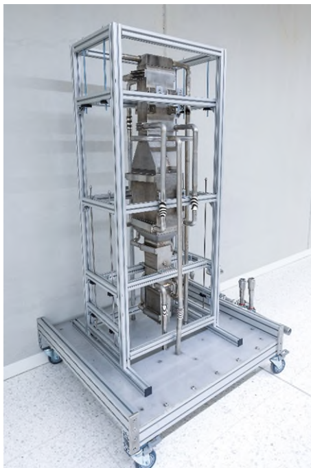
Abb. 1 Pilotanlage des Fraunhofer IMM für das Ammoniakcracken mit einer Kapazität von 20 kg/h Ammoniak
