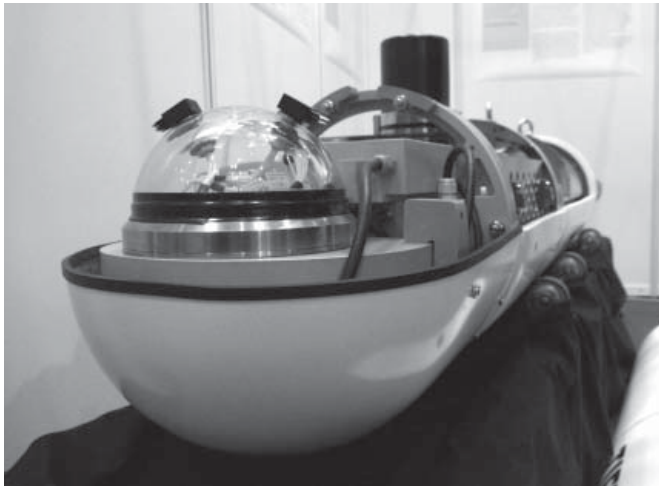
Der torpedoartige Unterwasserroboter soll bis 6000 Meter tief tauchen können. (© Fraunhofer AST)
